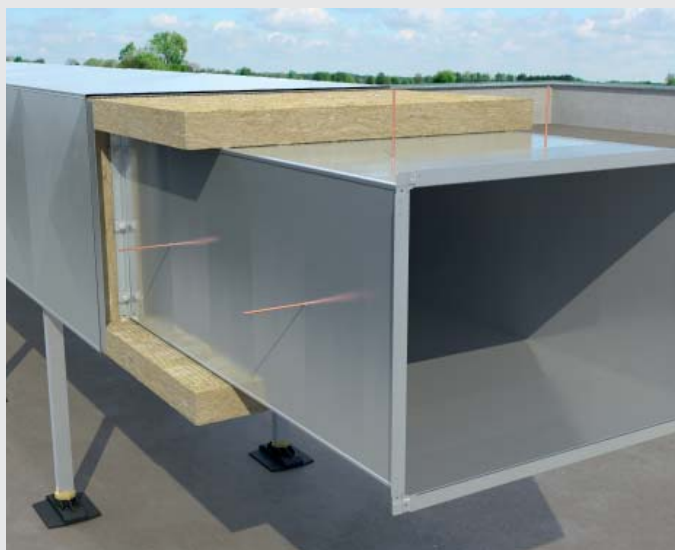
WIZ. 3. Mocowanie arkuszy stalowej blachy ocynkowanej jako płaszcza zewnętrznego.
